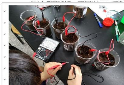
圖 32、依序串聯土壤樣本以檢測電壓
