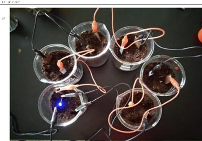
圖 33、串聯土壤樣本使 LED 燈發光
