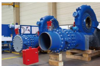
法蘭西斯水輪發電機組
