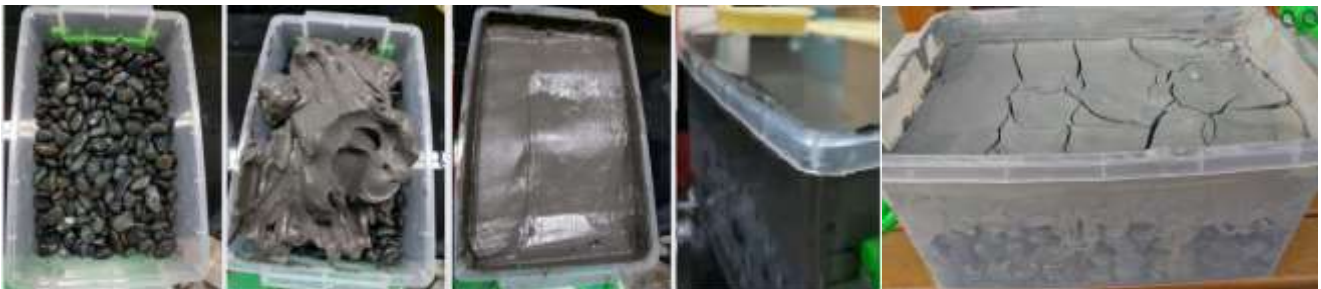
泥蓋透水實驗濕泥與乾裂泥
