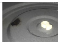
圖 3b 微波爐之熱點位置(黑漬處)
