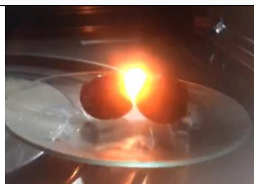
圖 1b 錶玻璃上 2 顆葡萄的電漿發光現象
