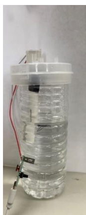
圖 1、含棉棒霧化器實驗照片
