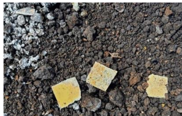
圖四 生物塑膠置於潮濕有機土中的發霉情況
