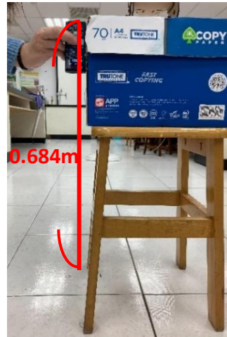
圖七 墊高發射器 (椅子+紙箱)固定
