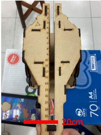
圖五 發射器拉距 (飛機尾端對齊 20 公分)
