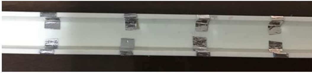
圖三 arduino專用軌道(側邊用導電膠帶相連)
