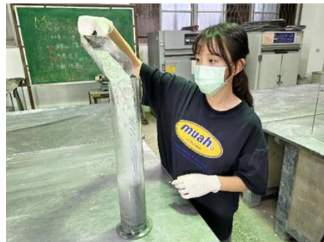
圖4：玻璃砂比重試驗
