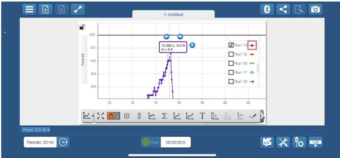
圖(四)以力量感測器下壓時果凍表面所承受的力圖
