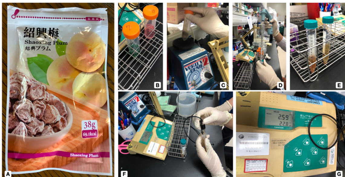
圖一、pH 值檢測方式記錄：A. 手摘果梅 (酸梅)、B. 測酸儀定位劑、C. 梅子放入離心管內加入 10ml 離子水，以混合振盪器混勻、D. 移液器粹出、E. 粹出之梅子液、F. pH 檢測、G. 檢測後結果。
