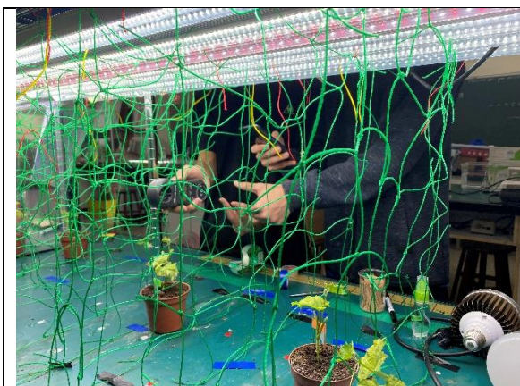
架設攀爬網並測量風速大小
