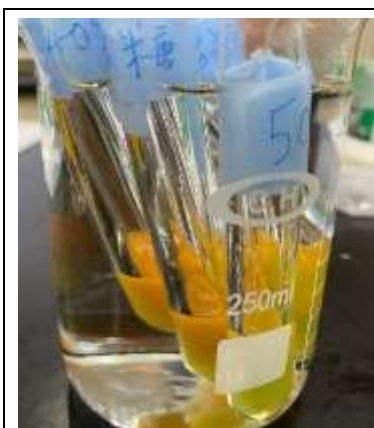
圖(1) 將不同濃度的葡萄糖水溶液，進行 70°C 水浴加熱。
