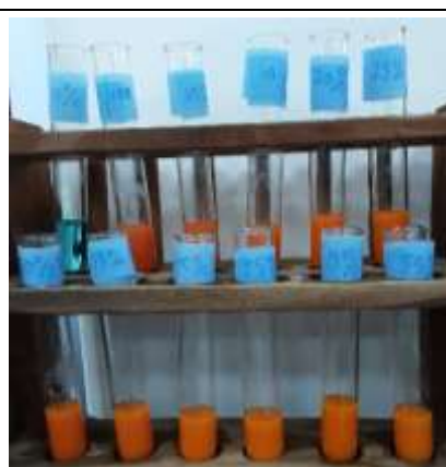
圖(2) 以 70°C 水浴加熱各濃度的葡萄糖和本氏液的混合溶液，其結果表示不論濃度為多少，在 70°C 的熱水加熱後，本氏液皆有產生顏色變化。
