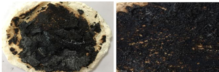
(圖四) 燃燒後，左為表面碳化現象，右為內部具有孔隙結構
