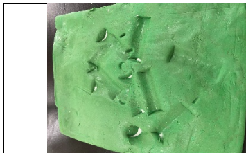
圖 7：油土被砝碼撞擊後的情形
