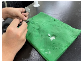
圖 8：測量油土的凹陷深度
