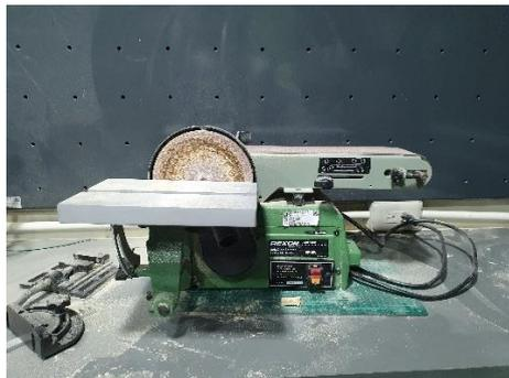
圖五 砂帶機
