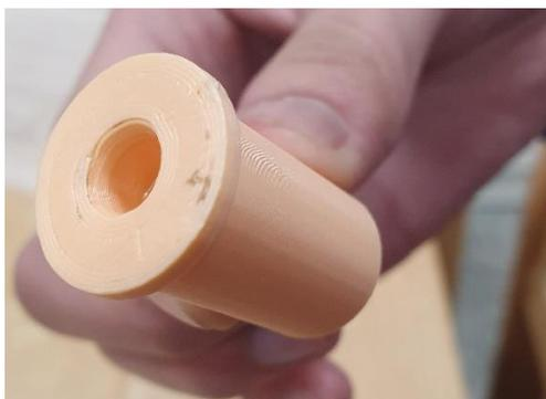
圖十 冷端出風口
