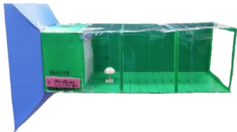
(圖三-3 已裝集風扇風洞右視圖)
