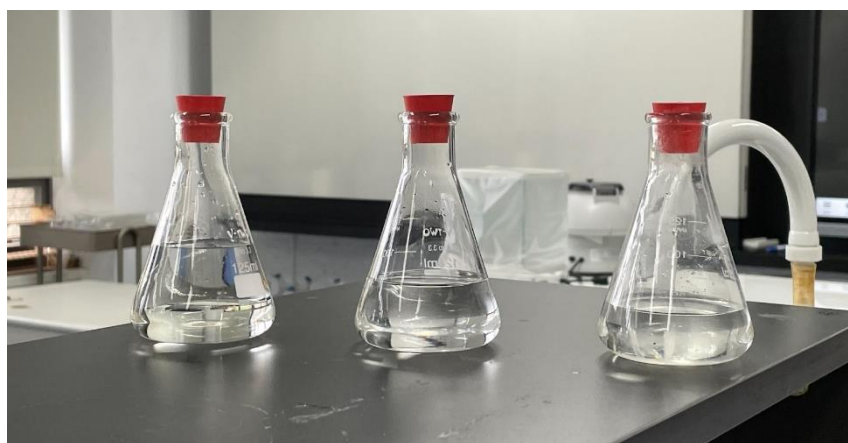
圖三 以不同溶劑萃取檸檬精油，由左而右之溶劑分別為水、酒精、丙酮
