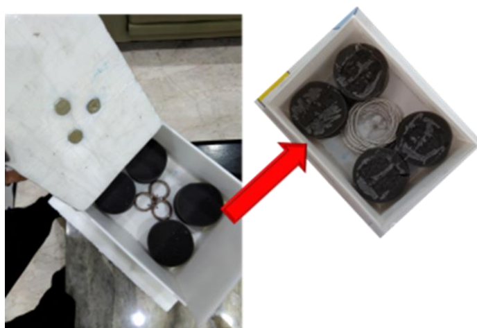
圖七 原本使用漆包線纏繞，但感應電流太小，因此改為 2.5\text{mm}^2 銅芯導線替換。
