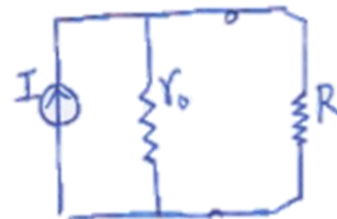
圖六 簡易電路圖，其中⊙為感應電流源、 r_0 為導線電阻、 R 為 Arduino 控制版內電阻。
