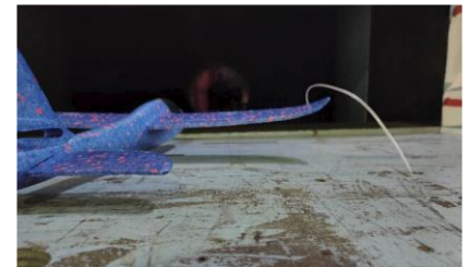
圖 6 插上細管測量壓力
