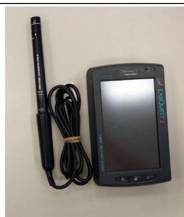
磁場感應器(高斯計) 型號：MG-BTA(單位：mT)
