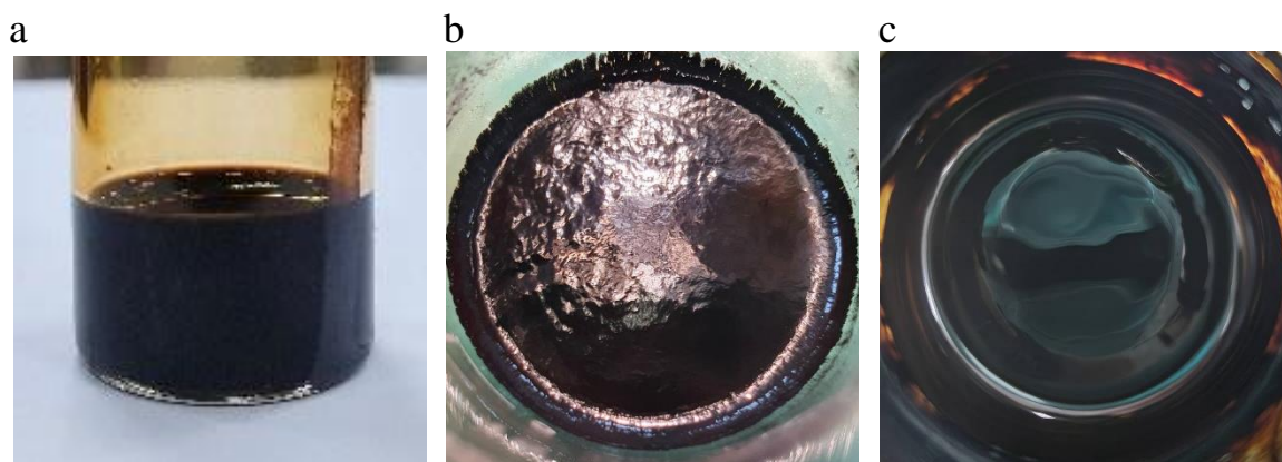
圖 3：不同油酸加入時機形成樣品之比較，(a) 無法沉澱至燒杯底部、(b) 可沉澱於燒杯底部、(c) 流動性佳具磁性的樣品
