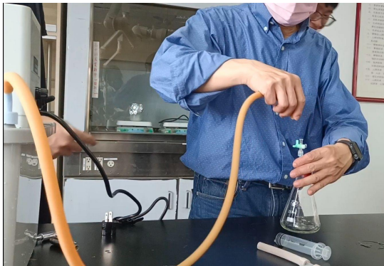
（圖四）針筒嘗試將乙醚減壓
