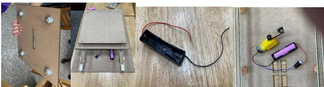
圖(十五)、(十六)、(十七)、(十八)最上層平台組裝、平台底板底部(輪子)電池盒、馬達焊接照
