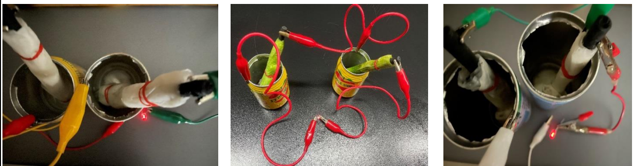
圖 6-1 使用自製不同的空氣電池 LED 燈發光
