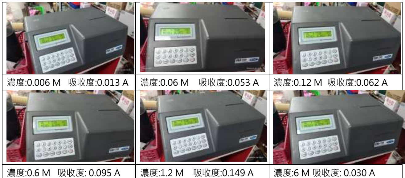
▲圖(五)鐵生鏽的程度與鹽水濃度關係
