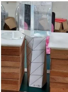
圖(四)底面正五邊形的 K 柱 扭轉95°的負重示意圖
