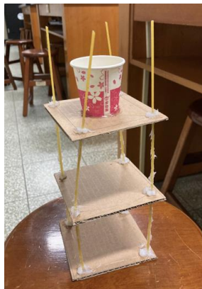
圖 7、黏貼加固法-結構圖
