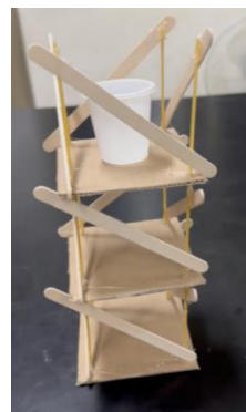
圖 4、三角形加固法 (冰棒棍)
