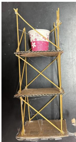
圖 5、三角形加固法 (義大利麵) 圖 6、仿水泥加固法-結構圖
