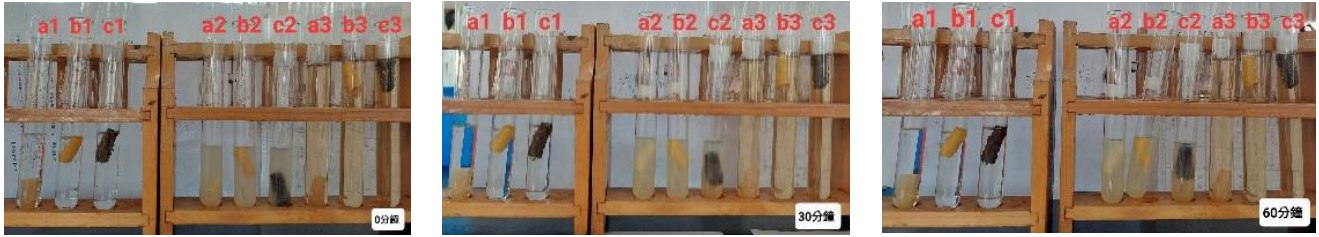
圖十四、浸泡飲料 0、30、60 分鐘 (a：檸檬皮吸管、b：橘子皮吸管、c：咖啡渣吸管)
