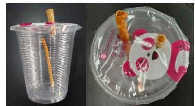
圖十一、戳膜測試
