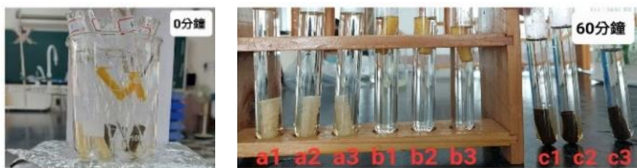
圖十三、浸泡熱水 0、60 分鐘 (a：檸檬皮吸管、b：橘子皮吸管、c：咖啡渣吸管)
