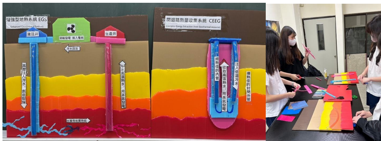
增強型地熱(EGS)和閉迴路熱量蒐集系統(CEEG)的模型
