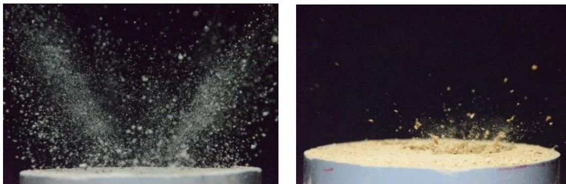
水滴打擊土壤試體瞬間的土壤飛濺現象
