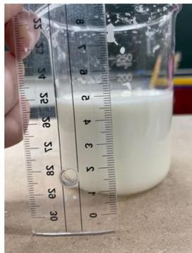
圖八、太白粉非牛頓流體起伏幅度測量
